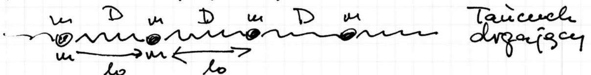
Gdy masy łańcucha będą coraz mniejsze oraz odpowiednio odległości pomiędzy masami będą coraz mniejsze, przejdźmy do ciągłego rozkładu masy o stałej liniowej gęstości
