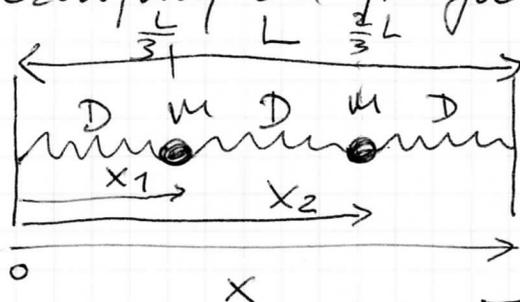
Rozpatrzmy drgania podłużne (tzn. wzdłuż osi x) układu
