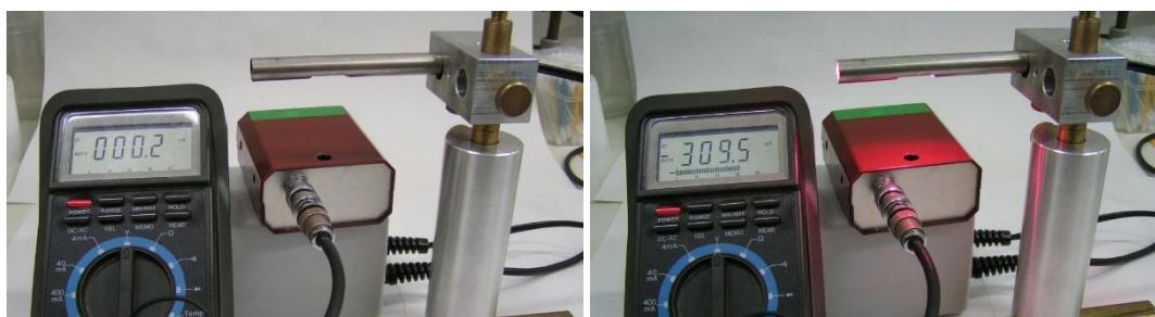
Rysunek 2. Działający detektor UV typu „solar blind” oparty na warstwie AlGaIn. Detektor oświetlony światłem dziennym generuje napięcie 0,2 mV, po oświetleniu lampą rtęciową napięcie generowane przez detektor wynosi powyżej 300 mV i jest mierzalne uniwersalnym multimetrem.
