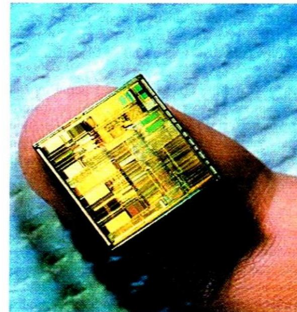
Rys 42.20. Układ scalony procesora Pentium wytwarzanego przez firmę Intel używany jest głównie w komputerach. Przed użyciem zostaje zamknięty w ceramicznej obudowie
